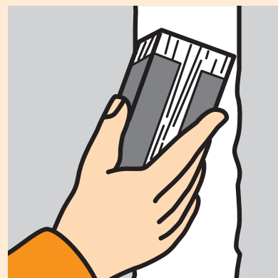
Les irrégularités peuvent être poncées après séchage
