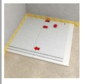
... et visser la Plaque de sol **fermacell** sur toute la surface du kit de douche à l'aide des Vis autoperçeuses **fermacell** (une distance d'environ 15 cm les unes des autres).
